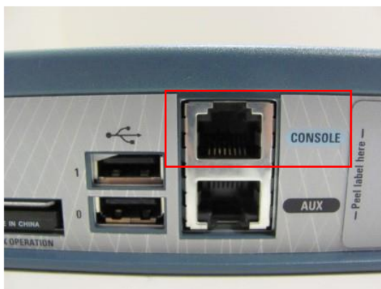
Slika 74. Prikaz konzolnog sučelja na mrežnom uređaju i konzolnog kabela za povezivanje računala i mrežnog uređaja-slika s interneta davno preuzeta ne znam izvor
