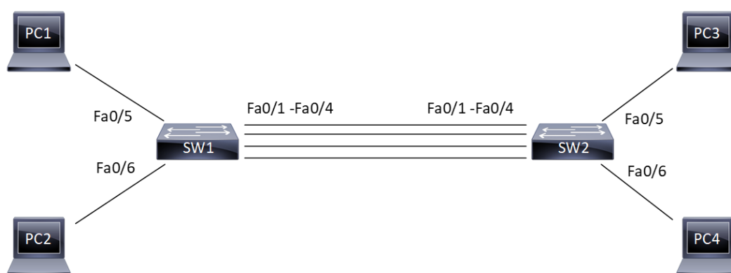
Slika 125. Primjer primjene Etherchannel mehanizma za povećanje redundancije i ukupne propusnosti između dva preklopnika
