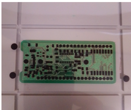
Slika 8.48. Prozirnica s otisnutom maskom za lemljenje.
