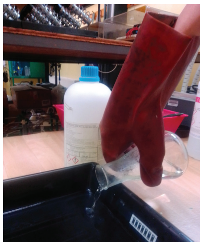
Slika 8.11. Izrada otopine za jetkanje, prvo voda zatim kiselina.
