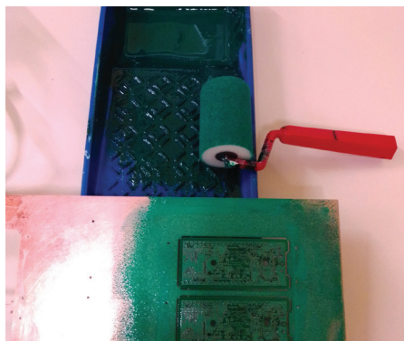
Slika 8.47. Nanošenje foto-osjetljivog laka.
