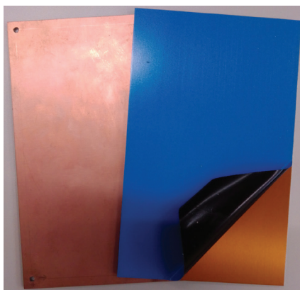
Slika 8.3. Tiskana pločica presvučena foto-osjetljivim lakom i zaštićena folijom.
