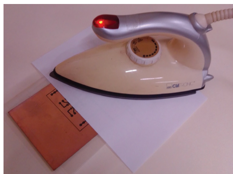
Slika 8.16. Transfer postupak topline s glačalom.
