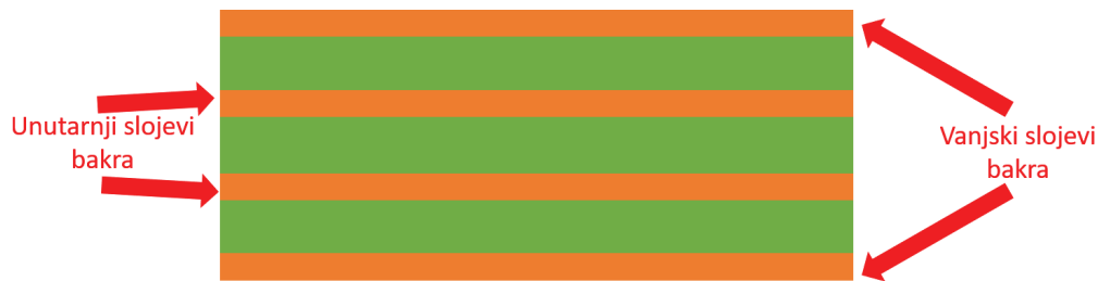
Slika 2.8. Pojednostavljeni prikaz četveroslojnog PCB-a.
