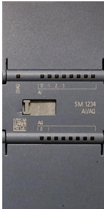
Slika 62. Modul analognih ulaza/izlaza PLC-a (rad autora)
