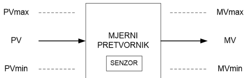
Slika 48. Simbolički prikaz mjernog pretvornika (rad autora)
