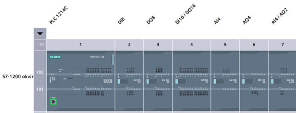
Slika 95. Hardverska konfiguracija (snimka zaslona iz softvera TIA Portal)
