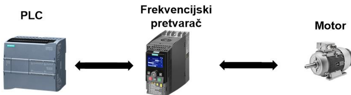
Slika 70. Spoj frekvencijskog pretvarača rad autora)
