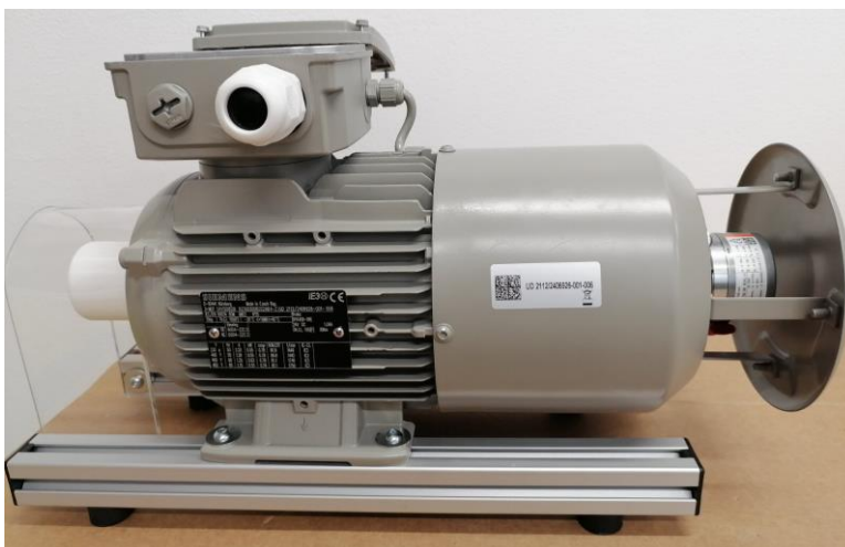
Slika 67. Asinkroni motor (rad autora)
