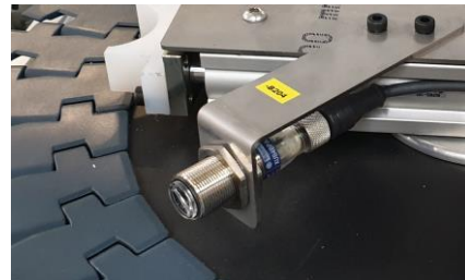
Slika 75. Montaža senzora blizine (rad autora)
